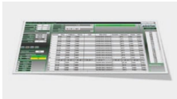
Управляющая программа предоставляет данные о ситуации на складе в режиме реального времени, получает задания по загрузке, перемещению и возврату листов стекла в полностью автоматическом режиме благодаря интеграции с оптимизатором линии резки стекла. Эта же информация может быть предоставлена отделу по закупке материалов.
