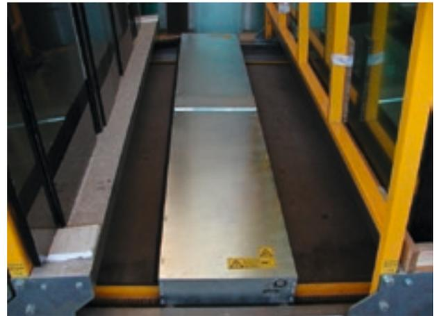
Перемещение элементов происходит с помощью приводной тележки, которая движется по зубчатой рейке и с помощью фотоэлементов позиционируется в соответствии с выбранной рамой
